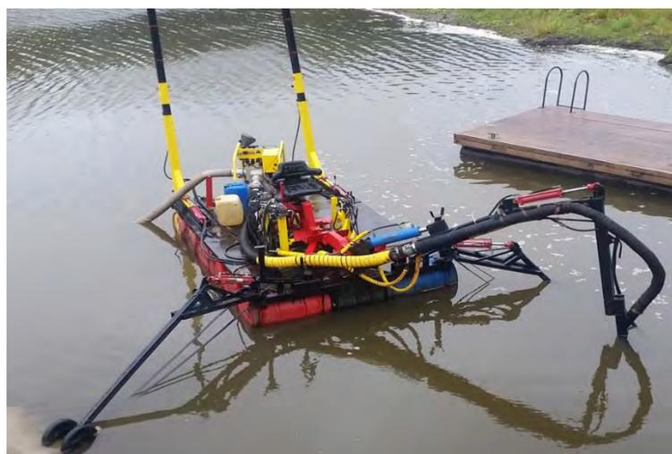
Рисунок 1 — Использование земснаряда для очистки участка реки
