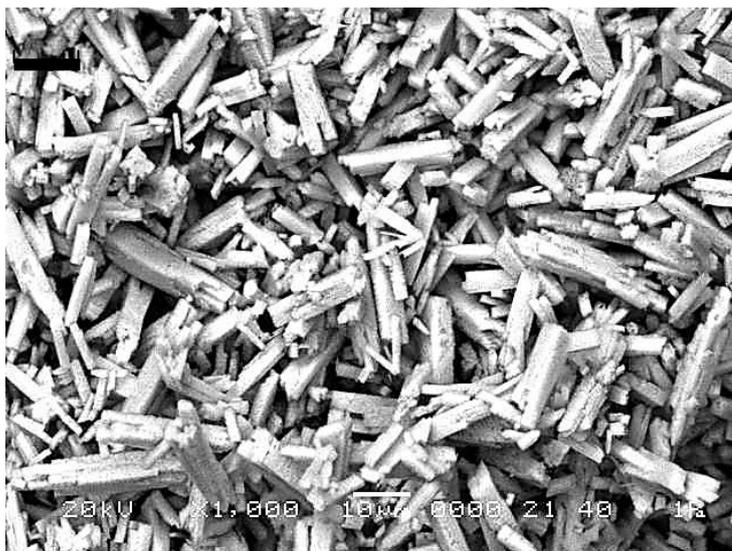
Рисунок 3 – Микрофотографии образцов, полученных из отработанных электролитов цинкования
