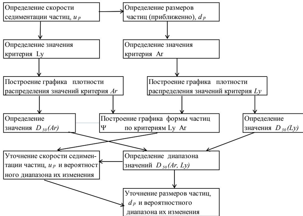
Рисунок 1 – Блок-схема последовательности определения диапазона величин скорости седиментации частиц  $u_p$  и соответствующих им эквивалентных размеров частиц пыли  $d_p$
