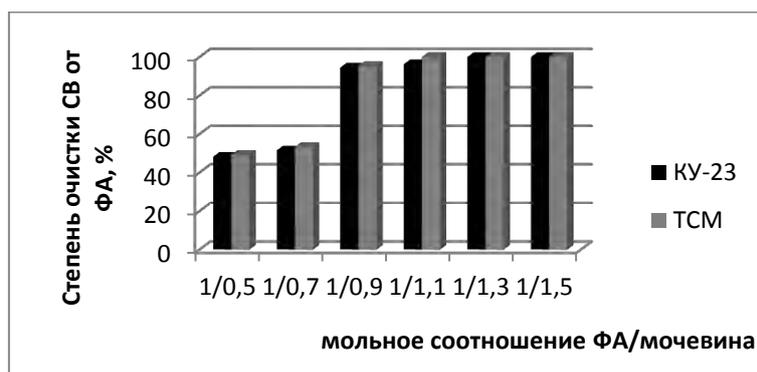
Рисунок 2 – Зависимость степени очистки СВ от ФА при различном мольном соотношении ФА: мочевины на гетерогенных катализаторах КУ-23 и ТСМ.
